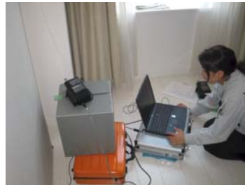
▲PCで臭気浸入状況を監視
