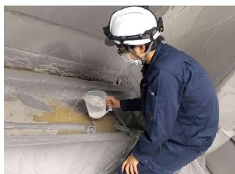
①水洗式塗装ブース貯水槽へ投入
