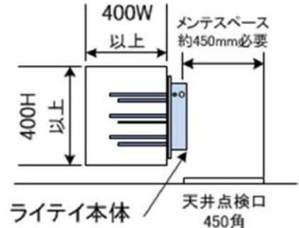
ライテイの入口には、上記に示す最低2W程度の直管部を設け、整流部に取り付けます。
